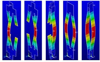
(a) Type (a) (b) Type (b) (c) Type (c) (d) Type (d) (e) Type (e) Fig. 2 Vibration modes of force sensor.
